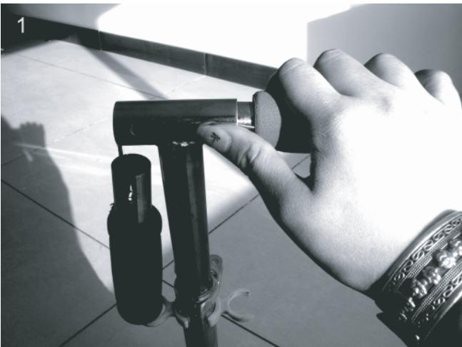
1. Encaixe as manoplas, pressionando o pino da mola. Deslize a manopla pelo encaixe na barra T até ouvir um click e o pino encaixar-se com o furo da barra T.
