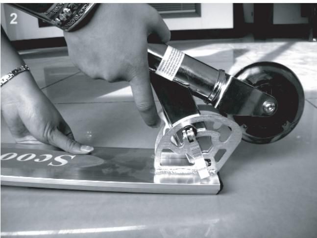
2. Com uma mão segure a base e com a outra levante a trava liberando a barra T. Levante a barra T até ouvir um click.
