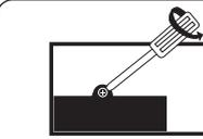
Use uma chave de fenda para retirar o parafuso na direção indicada.
