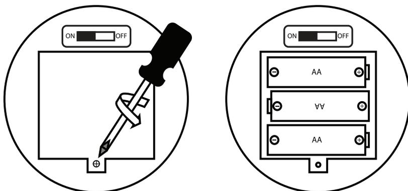
1. Solte o parafuso da tampa do compartimento de pilhas.
