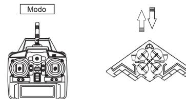
• Com o drone no ar, lentamente reduza a força de aceleração para trazer o Star Hunter de volta ao solo. Continue praticando este movimento afim de proporcionar sempre, pousos suaves e evitando riscos de avarias e danos.
