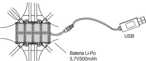
Com o drone posicionado em local plano, desligue sua chave de força (posição OFF) e conecte uma extremidade do carregador USB na bateria do drone. Encaixe o plugue USB em qualquer dispositivo que se conecte a ele e observe os sinais luminosos. Uma luz vermelha se acenderá indicando que a bateria está sendo alimentada, e logo em seguida se apagará. Quando a bateria estiver completamente carregada, a luz vermelha novamente irá se acender.
